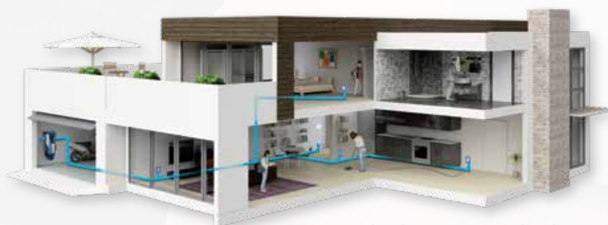
Esempio di casa con aspirazione centralizzata
